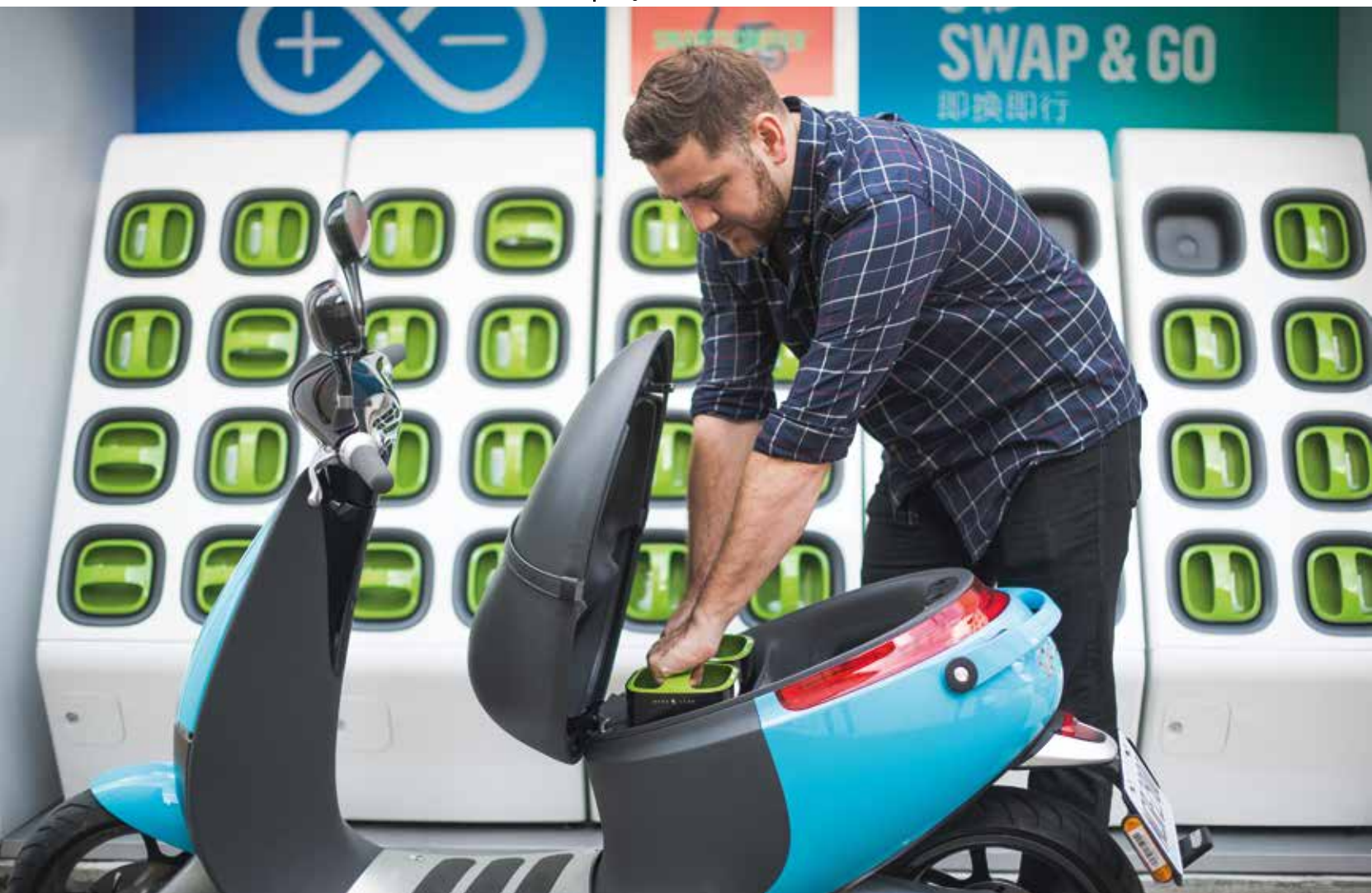
Vorbild Taiwan: Die Gogoro-Akkuwechselstationen sind in ihrer neuesten Version (GoStation 3.0) bidirektional ausgelegt, so dass sie auch netzdienliche Aufgaben übernehmen können.
